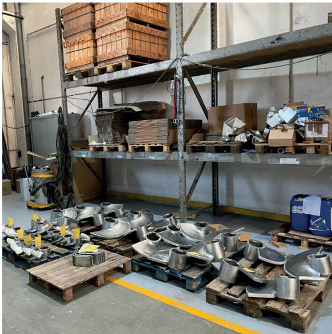
Für die Ziegelindustrie optimiert und regeneriert das Unternehmen Latermec Komponenten und Ersatzteile im Formgebungs-Maschinenbereich – zum Beispiel Schnecken und Mundstücke.
