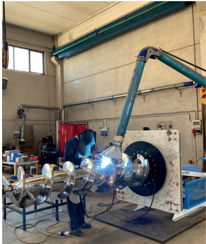
: Im Rahmen des verschleißfesten „Latermec Tenax“-Verfahrens erhalten die Schnecken eine Chromlegierung. Sie dient als Schutzlage und befördert den Rohstoff mit weniger Reibung über die Oberfläche.
