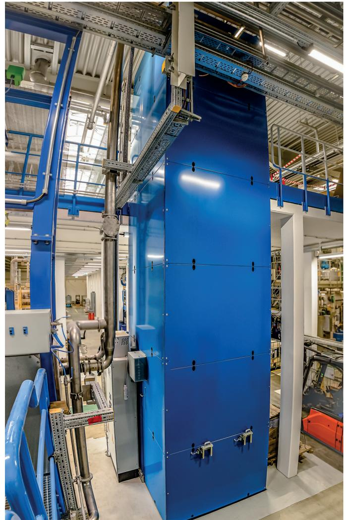
Vollverkleideter Vertikalförderer mit Sicherheitsvorrichtungen
