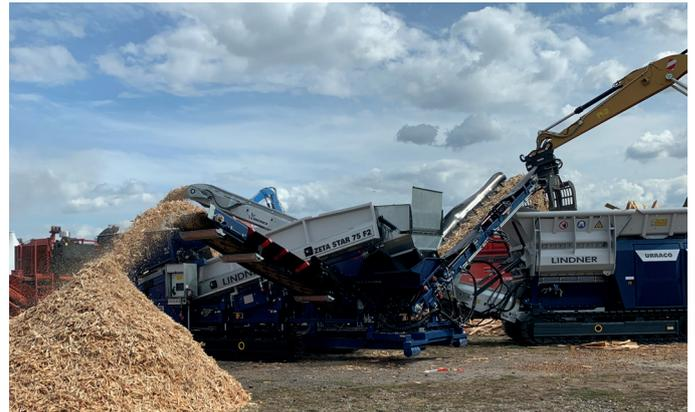
Bei Frischholz fördert ein 2-Fractionen-Sternsieb die Überlängen zurück in den Brecher. Das gesiebte Material im Vordergrund des Bildes hat einen geringen Feinanteil, deshalb werden lediglich die Überlängen getrennt und in den Brecher zurück gefördert.
