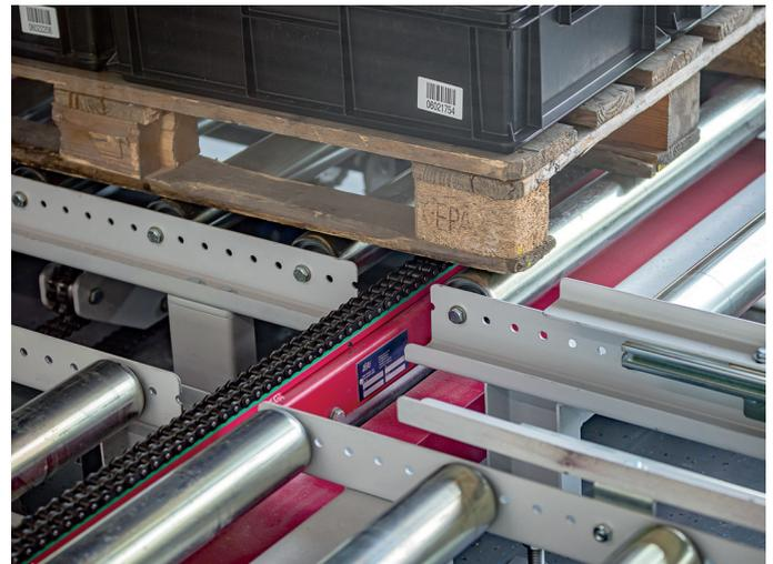
Die Zusammenführung der zwei Förderstrecken erfolgt platzsparend mittels eines Exzenterhebers in Kombination mit einem Kettenförderer.
