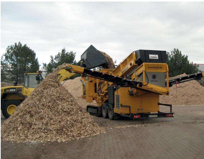
Bei Altholz mit hohem Feinkornanteil kommt das 3-Fractionen-Sternsieb zum Einsatz. Es trennt Überlängen und Staub von der Gutfraktion, welches dann nachtrocknet und mit gutem Wirkungsgrad verbrannt wird.
