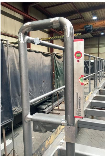
Bereits in der Vormontage werden alle Komponenten passgenau ausgerichtet.
