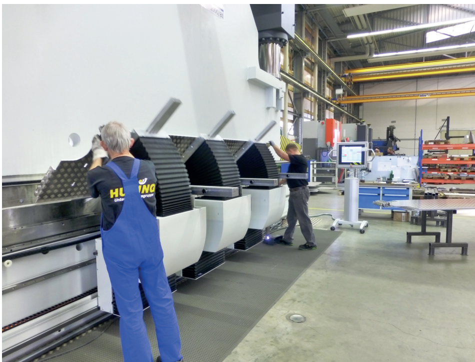
NEUE ANLAGE KOMMT AUF 10.000 t PRESSKRAFT UND ERLEICHTERT DIE ARBEIT ENORM (FOTO: HUNING)
