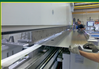
Abkantpresse 1.000 t Presskraft, bis 8 m Länge
