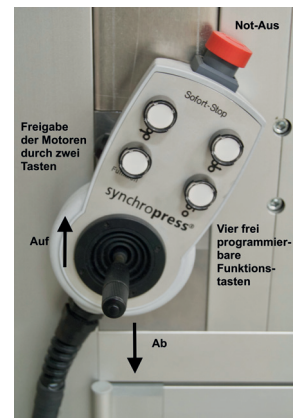
JOYSTICK ZUM VERFAHREN DES STÖSSELS
