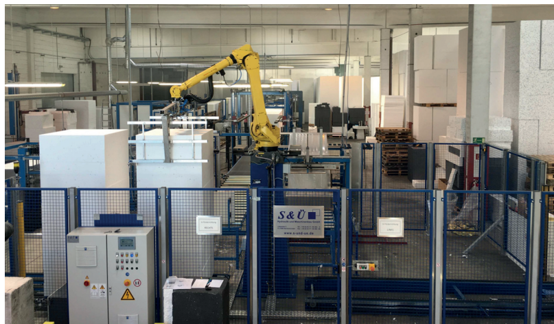
KOMPLETTSYSTEM DER FA. S&Ü: VERPACKUNGSLINIE FÜR STYROPORPAKETE MIT FANUC ROBOTER / ZU- ABÖRDERTECHNIK UND SIEMENSSPS STEUERUNG (FOTO: S&Ü)
