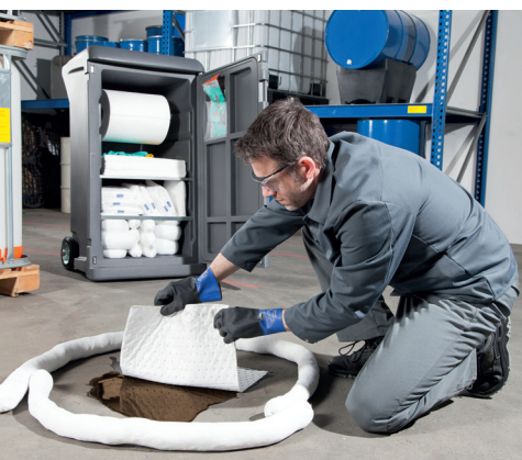
DENSORB DÄMMT LECKAGEN EIN UND NIMMT DIE FLÜSSIGKEITEN AUF.
