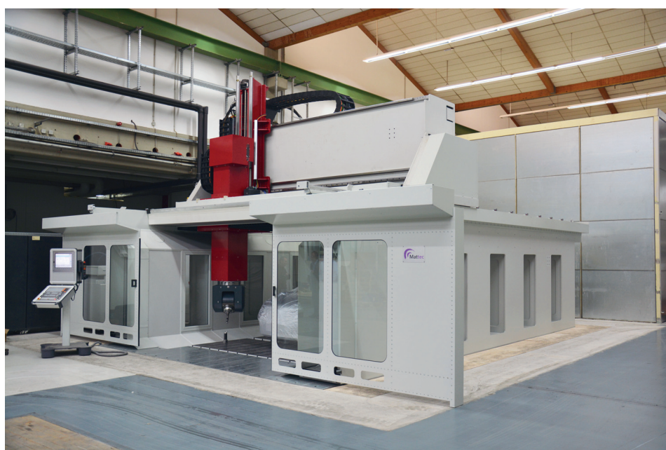
DIE NEUE 5-ACHS-HOCHPORTAL-FRÄSMASCHINE MATTEC 65-35-40 HIGH BEI EDAG IN FULDA; VON SIRTEC KONZIPIERT FÜR DAS DYNAMISCHE KOMPLETTBEARBEITEN/ SCHLICHTEN VON 1:1-FAHRZEUGMODELLEN AN BIS ZU SECHS SEITEN IM BEDIENERLOSEN BETRIEB
