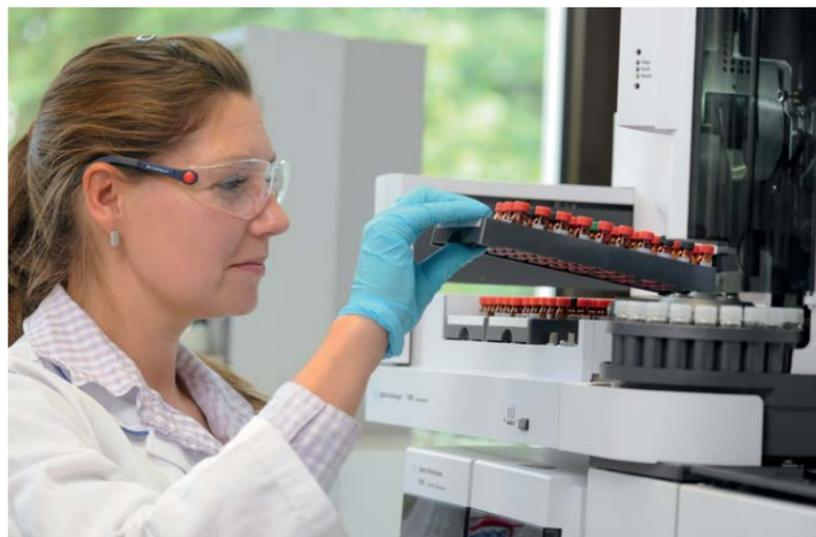
Mit Hilfe der Gaschromatographie lassen sich bei den angelieferten Rohwaren noch kleinste Spuren von Pflanzenschutzmitteln nachweisen.
