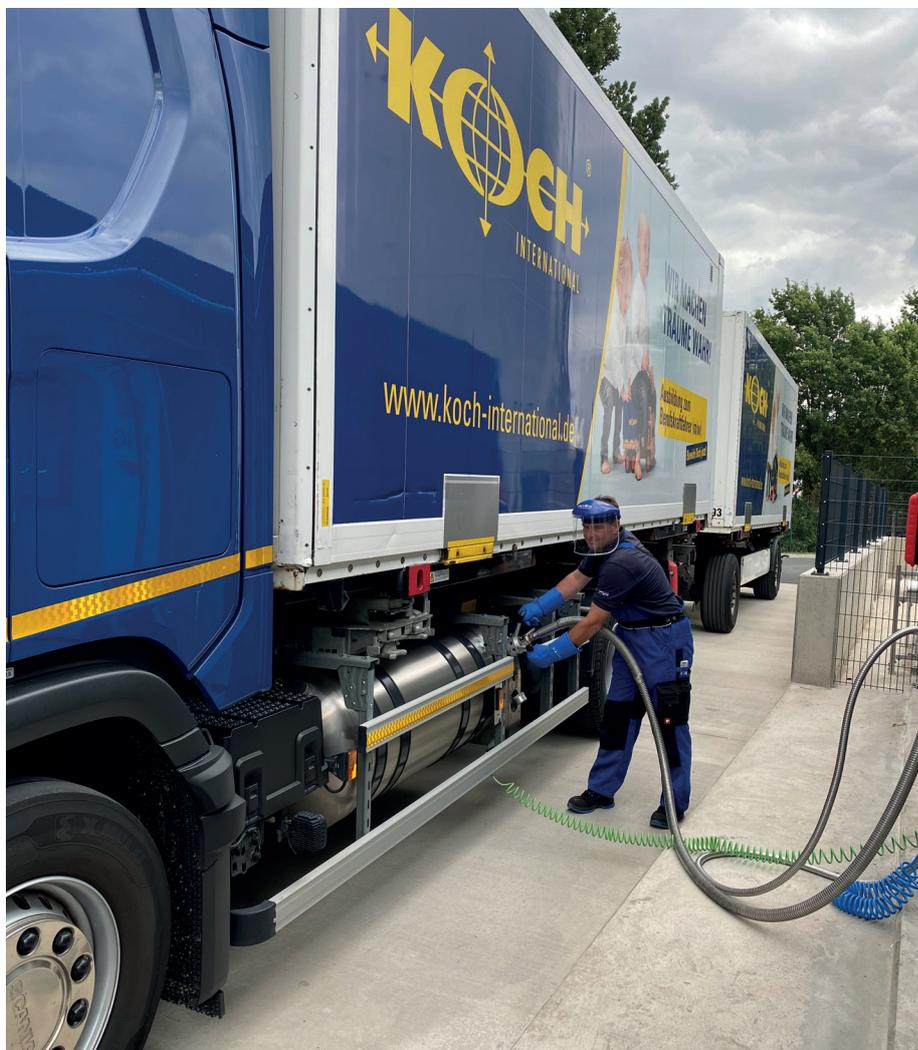
Erdgas wird bei unter -161 Grad flüssig – also zu LNG. Die Fahrer tragen daher beim Tanken eine Kälteschutzrüstung und müssen auf den richtigen Druck achten.
