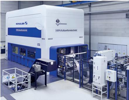
Vollautomatisch verketten sich diese Maschinen und produzieren Bauteile für Kfz-Getriebe.
