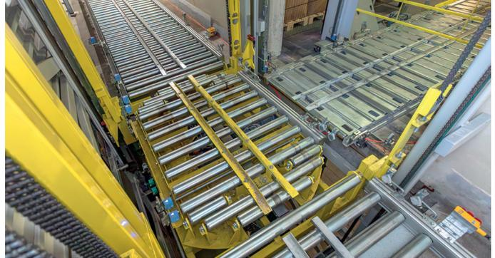
Vertikalförderer mit integrierter Drehstation für dreiseitige Rollenbahnanbindung
