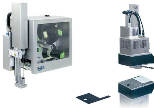
Blasbox: Für empfindliche Oberflächen wie zum Beispiel bei Obst- und Gemüseverpackungen. Für das schnelle Etikettieren im Durchlauf oder Stillstand. Die Etiketten werden von einem Lüfter angesaugt und von einem kräftigen Luftstoß durch ausgerichtete Düsen abgeblasen.
