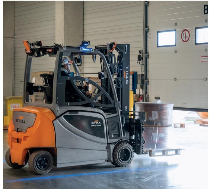
Die funkbasierte Zonenerkennung unterstützt die Betriebssicherheit – etwa durch eine automatische Geschwindigkeitsreduzierung in bestimmten Bereichen oder die Öffnung von Toren bei Annäherung eines Fahrzeuges.
