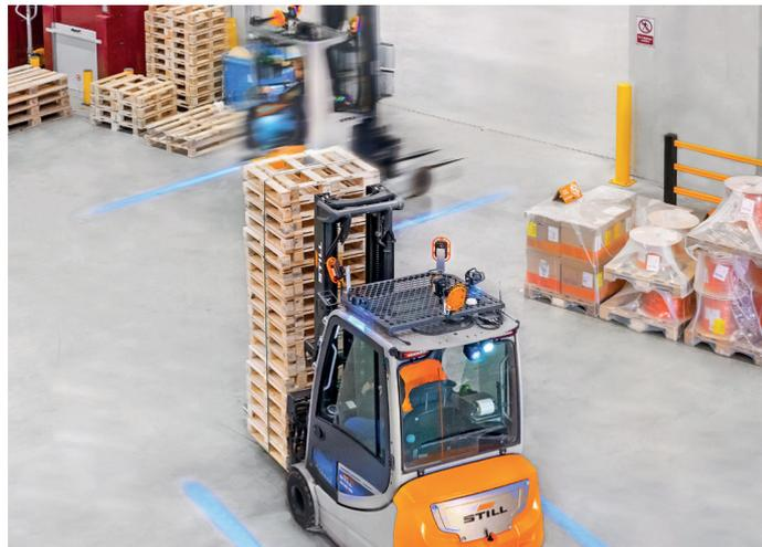
Die Fahrzeuge wurden mit einem funkbasierten Assistenzsystem zum Kollisionsschutz ausgerüstet. Zusätzlich warnt das Warnzonenlicht vor herannahenden Fahrzeugen.
