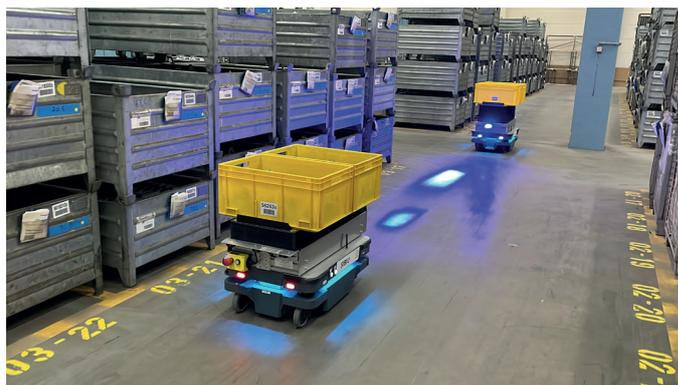
Mit „FTS“, fahrerlosen Transportsystemen, wird ein automatisierter innerbetrieblicher Produkttransport sichergestellt.
