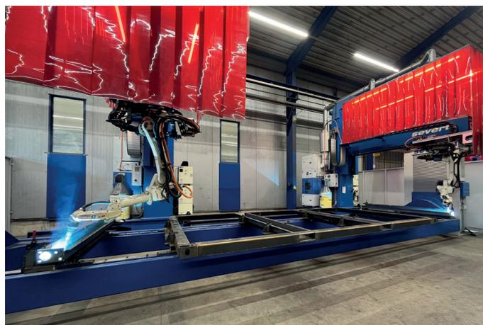
12 Meter lange Schweißbaugruppen sind nun mit den neuen Severt Schweißrobotern bei Peters Maschinenbau möglich.
