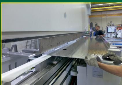
Abkantpresse 1.000 t Presskraft, bis 8 m Länge
