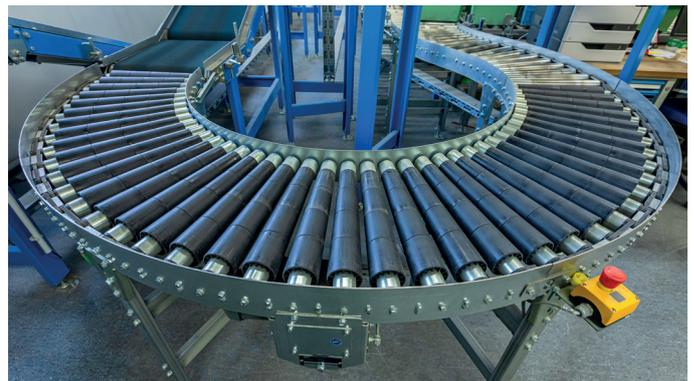
Angetriebene Rollenbahnkurve für den zuverlässigen Transport der KLT-Behälter mit Richtungsänderung.
