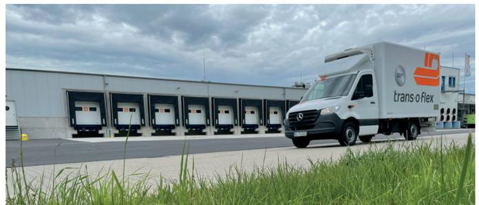
Äußerlich kaum ein Unterschied, aber im Betrieb deutlich leiser und sauberer: eines der drei Testfahrzeuge mit elektrischer Kühlung. Die ersten von 174 neuen Fahrzeugen sollen Mitte des Jahres ausgeliefert werden. Die drei Testfahrzeuge laufen inzwischen im Regelbetrieb.
