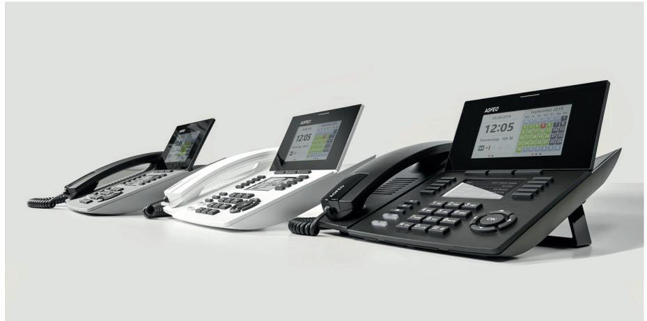
ohne separaten Ausdruck. Ein weiteres Feature ist der Standby-Modus im Dark Mode. Auch hier kommt der Annäherungssensor zum Einsatz. Ein echtes SENSORfon eben! Nähert man sich dem Telefon mit der Hand, geht das Licht von alleine wieder an – ebenso wird die Tastenbeleuchtung wieder eingeschaltet.
