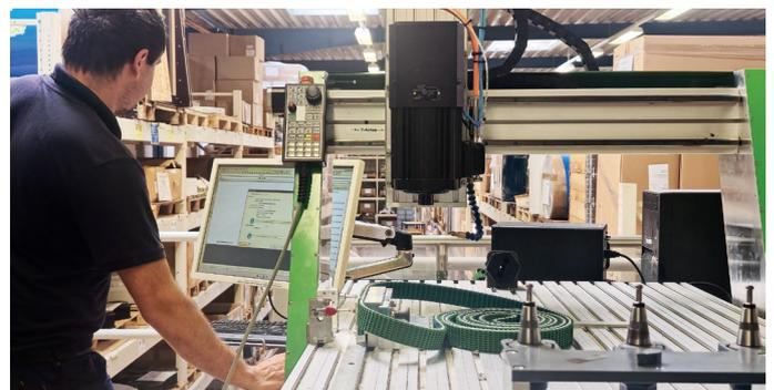
Bohren oder Fräsen von Löchern an präzisen Positionen, um die Montage von Endanbindern oder anderen Verbindungselementen zu erleichtern.
