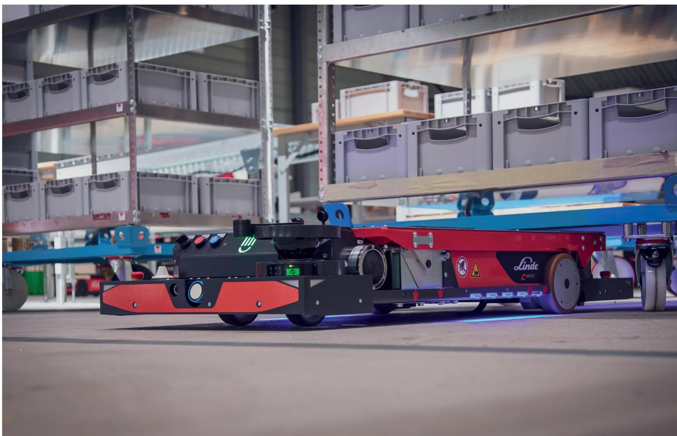
Unermüdlicher Transporthelfer: Dank seiner leistungsstarken Li-ION-Batterie ist der Linde C-MATIC HP auch für 24/7-Einsätze prädestiniert. Im Bedarfsfall steuert das bis zu 8 km/h schnelle Gerät selbstständig seine Ladestation an.
