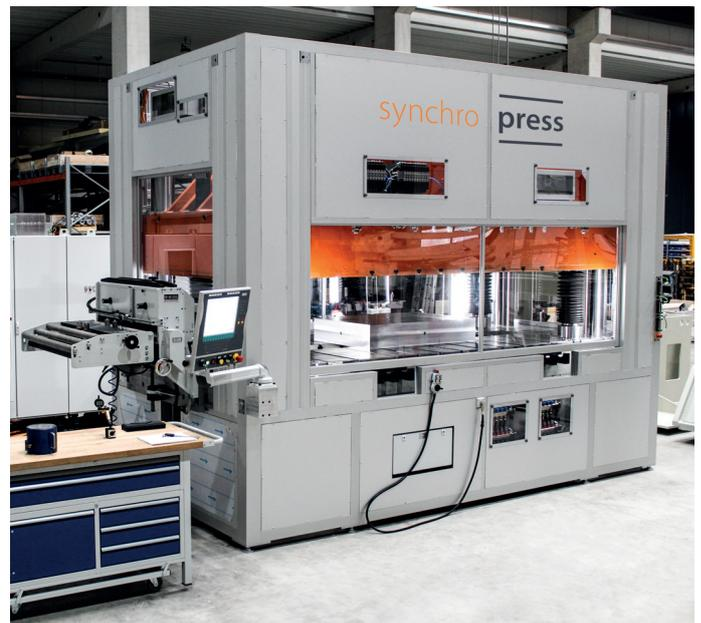
Die Antriebstechnik einer synchropress® basiert auf einem auf Effizienz ausgerichteten Energiemanagementsystem. Aufgrund der Funktionsweise einer synchropress® wird durch die Presse während des Pressenhubes nicht nur Energie verbraucht, sondern zeitweise sogar erzeugt. Diese während jeden Hubs erzeugte Energie wird genutzt, indem sie in Zwischenkreise eingespeist und der Presse vor
