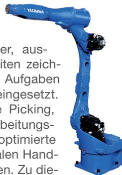
📷 Die schlanke Bauweise und große Reichweite des neuen Motoman GP8L von Yaskawa ist ideal geeignet für das schnelle Entleeren von Teilebehältern. - Foto: Yaskawa
