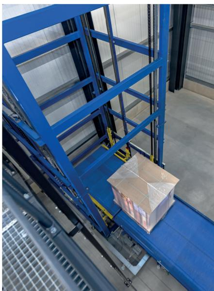
förderern sollten die Distanz, ebenso wie die Höhenunterschiede zwischen den Gebäuden überwinden und der Forderung eines automatisierten Transports gerecht werden.
