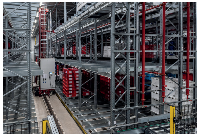
Dieses Einmast-Regalbediengerät im Hochregallager der Unternehmensgruppe Tönnies in Badbergen überzeugt durch ein besonders niedriges Anfahrmaß.
