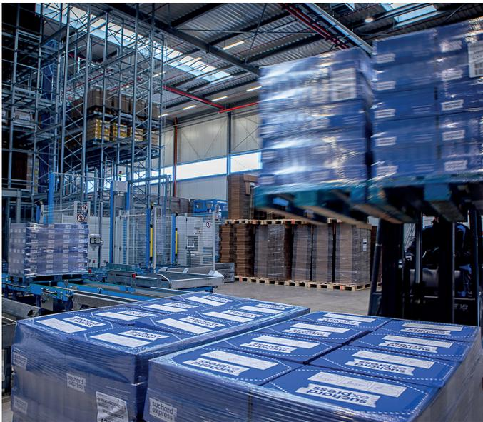
Schnittstelle zum manuellen Staplerbetrieb: Europaletten werden paarweise aufgegeben, vereinzelt und eingelagert. Die besonders materialschonende Satellitentechologie eignet sich z. B. auch für Kartonagen.
