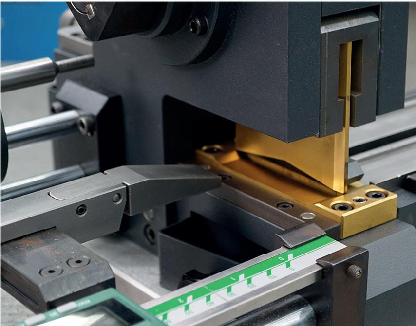
**D**as Multifunktionsgerät mcut|multi des Heilbronner Materialhändlers Marbach Die Supplies schneidet Linienmaterialien schnell und ohne Verformung. Damit können Werkzeuge in der Stanzwerkzeug-Vorbereitung optimal auf ihren Produktionseinsatz vorbereitet werden.
