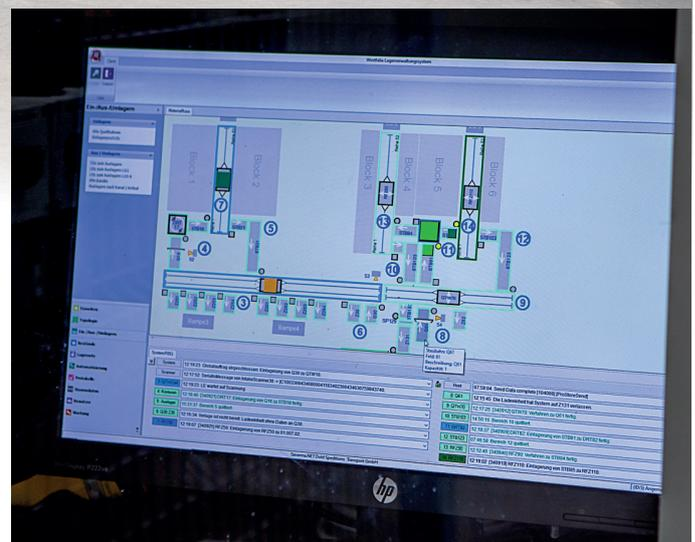
Zwei automatische Lagersysteme in einer Halle, doppelte Lagerkapazität: Das Warehouse Execution System holt alle Prozesse auf einen Schirm.
