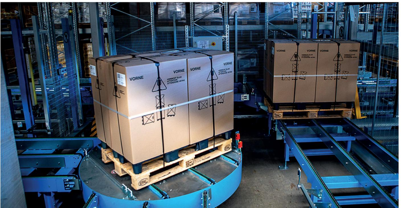
Ein- und Auslagerstrang wurden streckeneffizient und auf engstem Raum realisiert und auf eine besonders schnelle Einlagerung optimiert.
