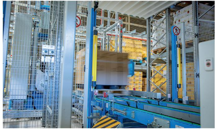
Die Fördertechnik übergibt die Ladeeinheiten besonders schnell an die Regalbediengeräte.
